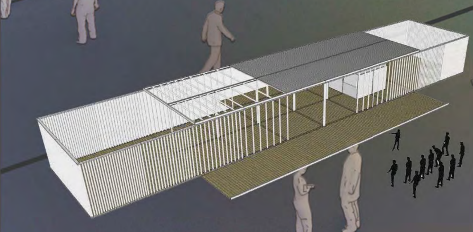
06-Terminación con pintura sintética blanca a los elementos metálicos. NOTA: la totalidad de los materiales empleados en la construcción son ensamblados mediante encuentros mecánicos con el fin de ser reutilizados en otra construcción.
