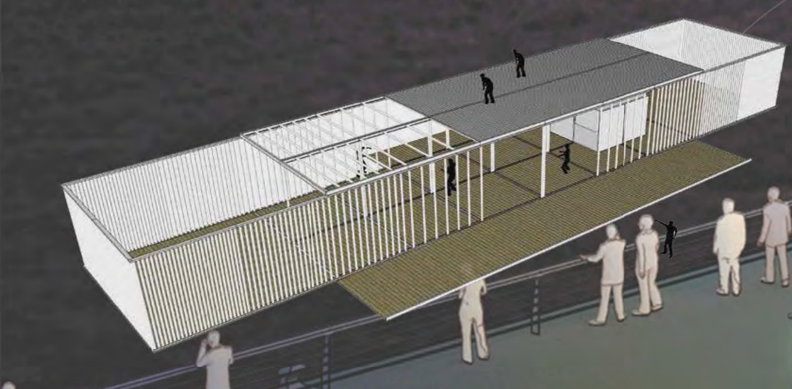
05-Colocación de chasas de fibra de vidrio traslúcidas color blanca (con la posibilidad de ser reutilizadas), tomadas mediante piezas omega tipo "U" para no perforar los caños de PVC.
